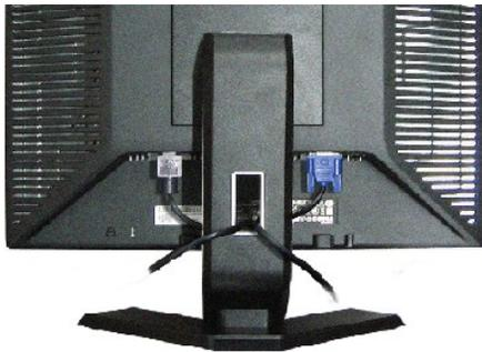
Verwenden Sie nach dem Anbringen aller erforderlichen Kabel an Ihren Monitor und den Computer (siehe [Anschließen des Monitors](#) für Hinweise zu dem Anschließen der Kabel) den Kabelhalter, um sämtliche Kabel wie oben abgebildet sauber zu verlegen.
